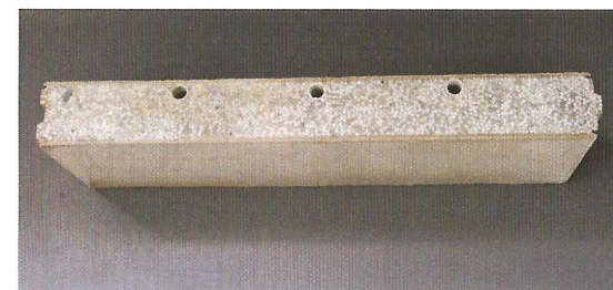
Dinding quipanel dengan konduit listrik
